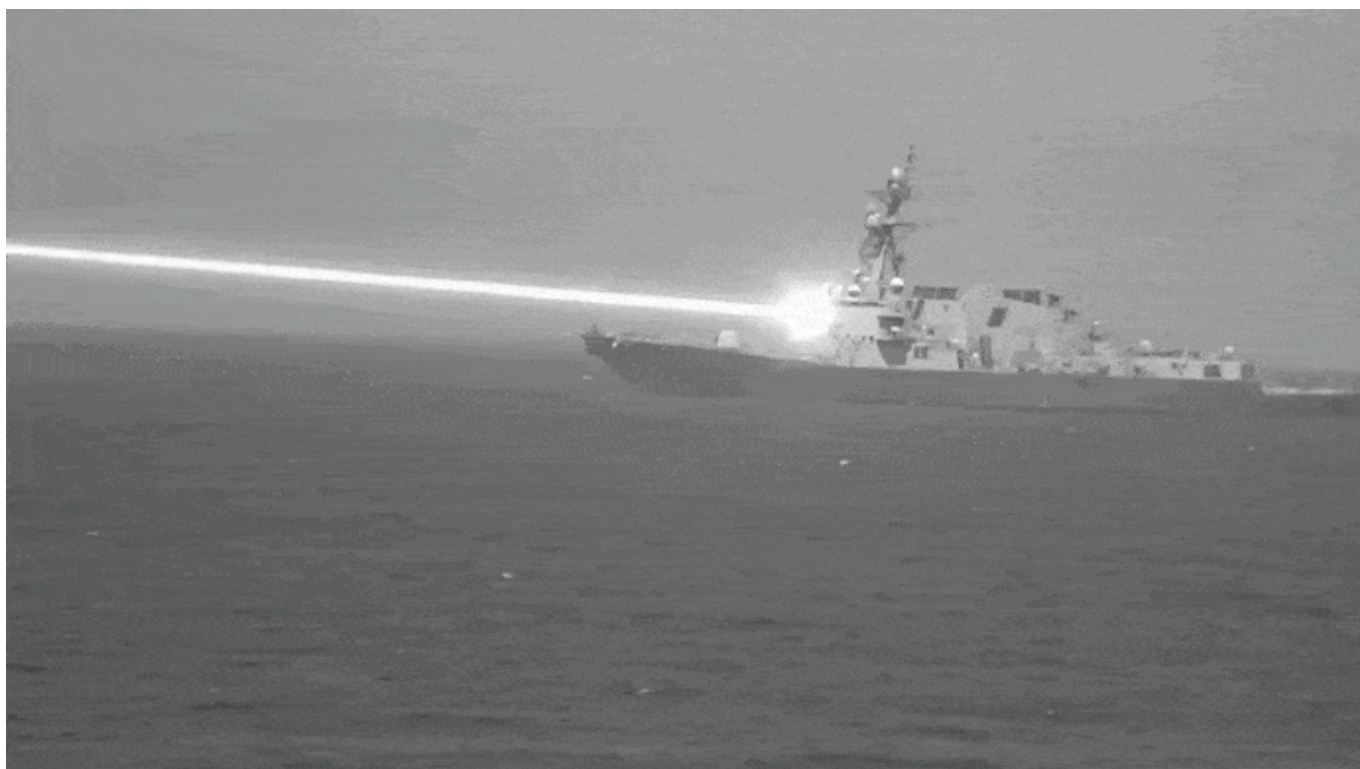
Испытание лазерной системы HELIOS на борту эсминца Preble класса Арли Бёрк DOT&E
